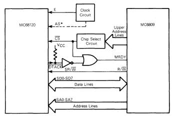
FIGURE 17 - MEMORY READY - DTACK CONFIGURATION
