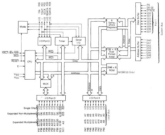
MC68120/MC68121 INTELLIGENT PERIPHERAL CONTROLLER - BLOCK DIAGRAM
